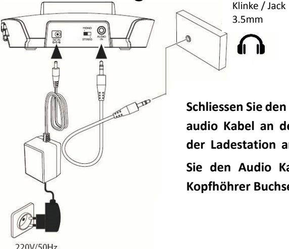
Schliessen Sie den Mitgelieferten 3,5mm audio Kabel an der 'AUDIO IN Buchse' der Ladestation an. Danach, schliessen Sie den Audio Kabel auf der TV-Kopfhörer Buchse an.
